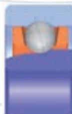
Шарикоподшипники разъемные, радиально- упорные (с углом контакта) поставляются смонтированными, но их внутреннее кольцо может быть отделено от остальной части подшипника для облегчения его монтажа в системе. Шарики остаются стоять устойчиво в сепараторе при помощи наружного кольца. Они имеют такие же свойства, как и шарикоподшипники неразъемные радиально- упорные.
