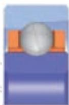
Эта конструкция позволяет интегрировать более шариков, чем шарикоподшипник с глубокой дорожкой качения, тем самым увеличивая допустимые нагрузки. Эти подшипники могут быть изготовлены с большими углами контакта. Это увеличивает допустимые осевые нагрузки в пределах глубины дорожки качения и эллипсовидного желобка.
