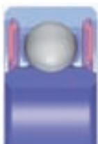
Подшипник с одним или двумя уплотнениями из нитриловой резины, с металлическим армированием. Контакт между уплотнением и внутренним кольцом обеспечивает отличную плотность. Однако это ведет к увеличению момента трения.
