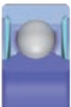
Подшипник защищен одним или двумя уплотнениями из PTFE, усиленными стекловолокном и удерживаемые стопорным кольцом. Этот тип уплотнения представляет хорошую плотность с меньшим моментом трения по сравнению с уплотнениями из нитриловой резины.
