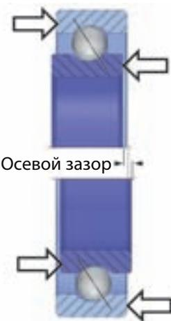
При нулевой измеренной нагрузке, осевой зазор зависит напрямую от радиального внутреннего зазора для данной конструкции внутренней части подшипника. Он определяется максимальным осевым смещением между внутренним кольцом и наружным кольцом при перемене направления вращения.
